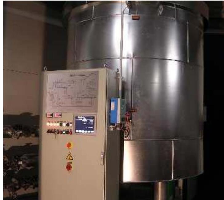
Isolierter Reaktor zur Substratbehandlung
