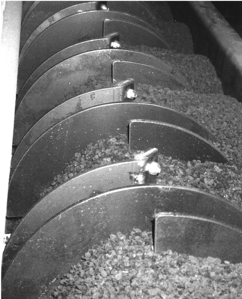
Bild 2: Heizscheibensegmente im Trockengut
